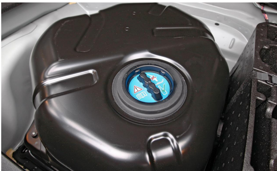
Obr.7. Príklad nádrže roztoku AdBlue[22]
