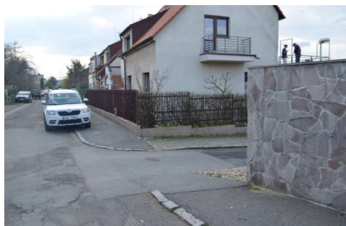
Obr. 72 Neprůhledný plot může být nebezpečný pro řidiče a chodce
