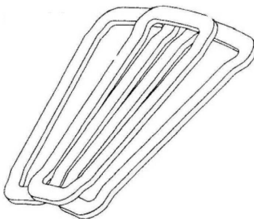
Obr. 1.7 Vinutí s překrývajícími se cívkami [1]
