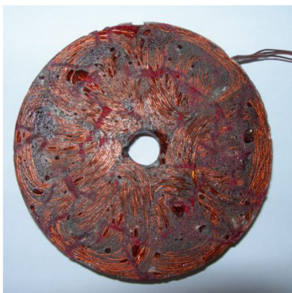
Obr. 4.1 vnitřní strana statorového vinutí stroje
