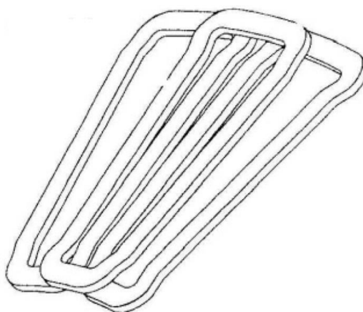
Obr. 1.7 Vinutí s překrývajícími se cívkami [1]
