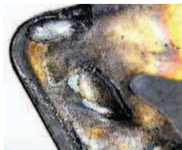
Výmol na čele
