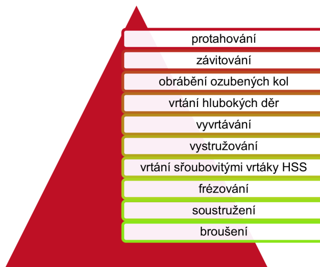
Obr. 14 Obtížnost obráběcích operací [34].
