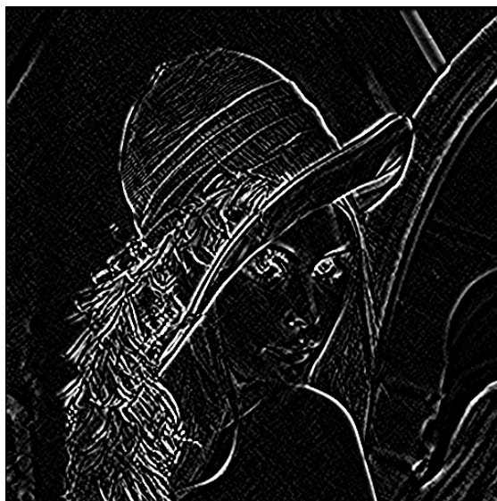
Obrázek 4: Zvýrazněné přechody (gradienty) získané aplikováním sobel operátoru.
