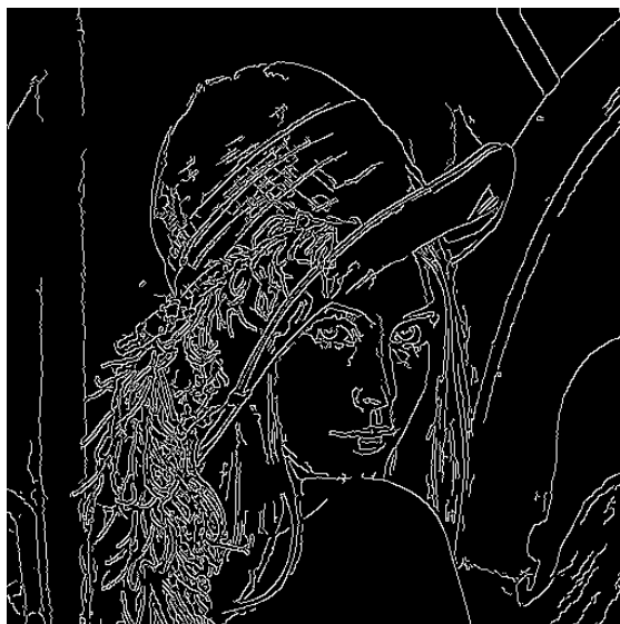
Obrázek 5: Demonstrace obrazu po aplikaci posledního kroku Cannyho detekce hran. Konkrétně v tomto případě byl v průběhu procesu využit ve čtvrtém kroku dvojitě prahování s hodnotami 30 a 85.
