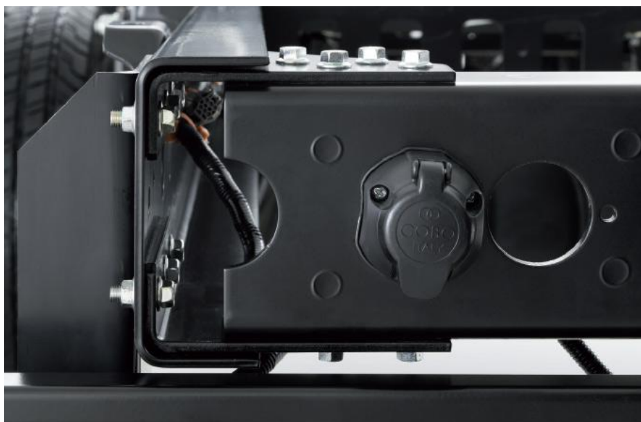
Obr. 3 Šroubové spojení koncového příčnicku s podélníkem [19]
