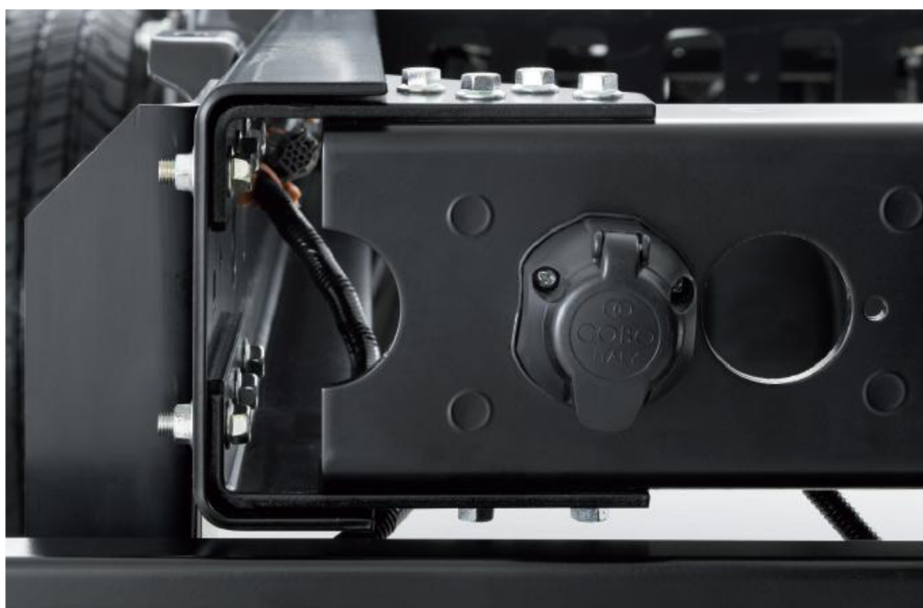
Obr. 3 Šroubové spojení koncového příčnicku s podélníkem [19]
