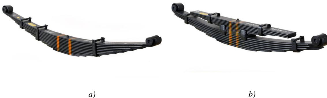
Obr. 13 Přehled listových pružin a) bez progresivního odpružení b) s progresivním odpružením [13]
