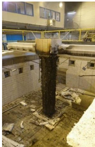
Obr. č. 23: Požární zkoušky prováděné před výstavbou budovy Mjøstarnet v Norsku [28]
