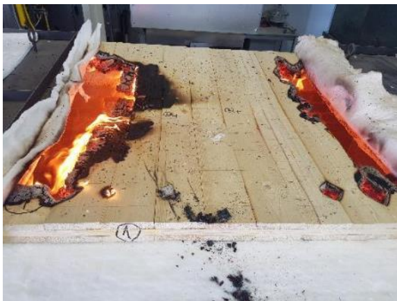
Obr č. 53: Zkušební deska s dřevěnými spojovacími prvky po ukončení zkoušky
