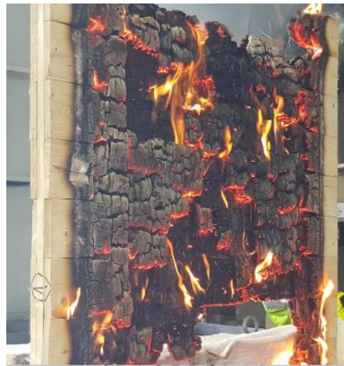
Obr č. 53: Zkušební deska s dřevěnými spojovacími prvky po ukončení zkoušky
