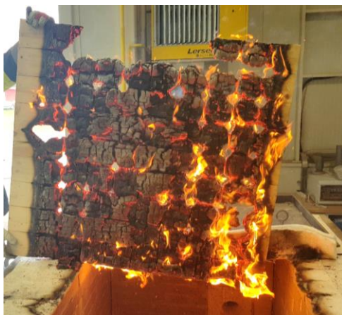
Obr. č. 54: Zkušební deska s ocelovými vruty po ukončení zkoušky
