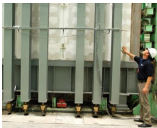
Obr. č. 39: Zkušební stěna z neohříváné strany po dvouhodinovém působení ohně o teplotě 1000 °C [33]
