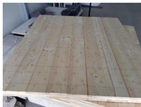
Obr. č. 49: Vyrobená vrstvená deska za použití dřevěných spojovacích prostředků.
