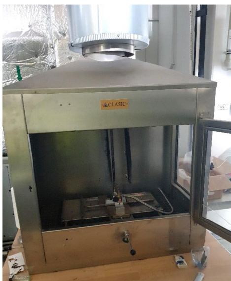
Obr. č. 8: Spalovací komora pro zkoušku Zápalnosti stavebních výrobků vystavených přímému působení malého plamene dle EN ISO 11925-2:2020
