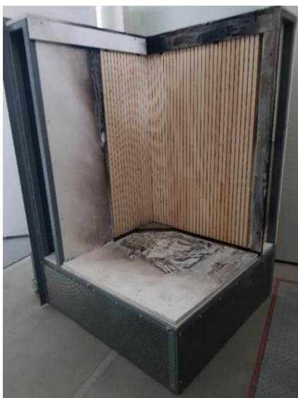
Obr. č. 7: Zkušební zařízení pro SBI test (Single Burning Item)
