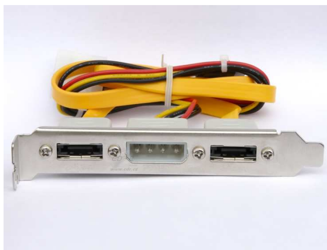
Obrázek č. 14: Záslepka počítače s dvěma konektory eSATA a napájením
