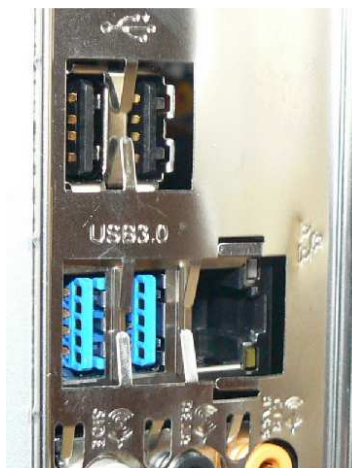
Obrázek č. 17: Náhled na USB 3.0 a USB 2.0 porty integrované na základní desce
