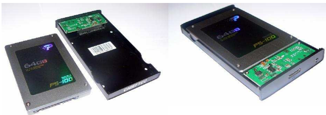
Obrázek č. 19: Disk Patriot PS-100 SSD a externí box Chieftec 2.5“ s konektorem mikro-B USB3.0
