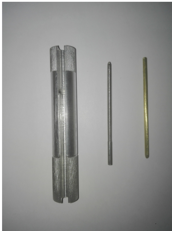
Obrázek 15: Fotografie obalu lana pro správné snímání fotorezistorem.
