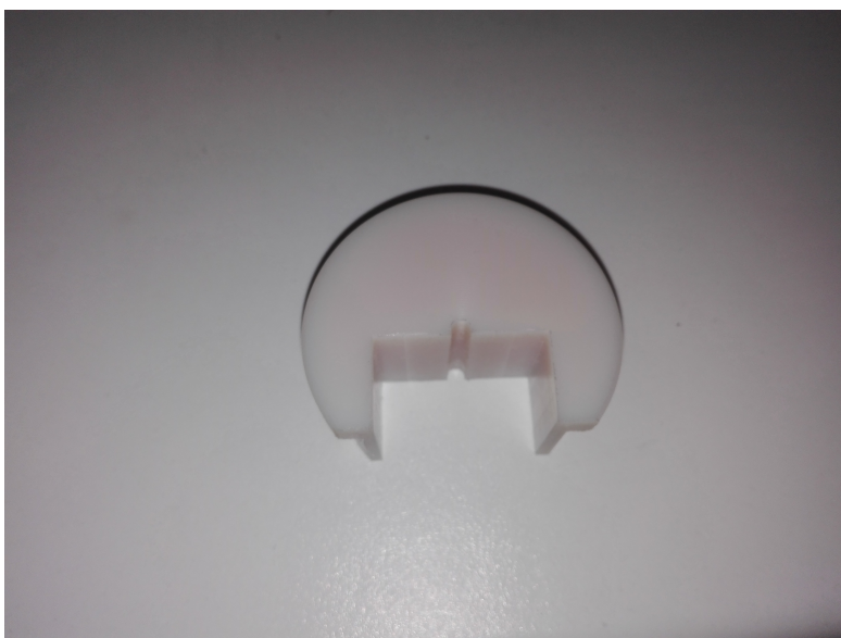
Obrázek 7: Plastová objímka lana, která slouží k vycentrování Charronova prstence.
