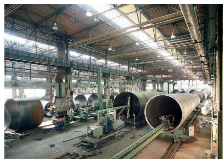
Rameno se svařovacím automatem je umístěno do tubusu.
