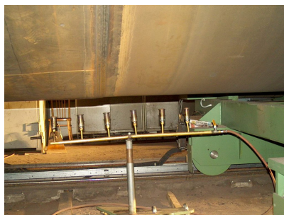
Plynové hořáky kontinuálně předehřívají oblast svaru
