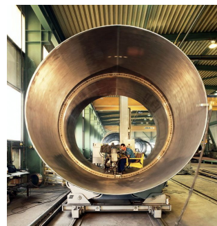
Přivaření příruby ke krajnímu prstenci.
