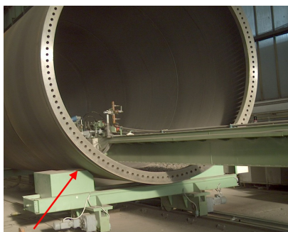
Rameno se svařovacím automatem je umístěno do tubusu.
