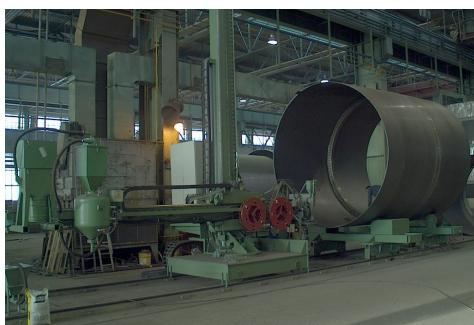
Přivaření příruby ke krajnímu prstenci.
