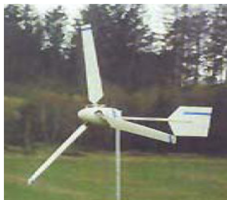
Obr. 31: Uspořádání rotoru (proti větru) s orientací rotoru pomocí kormidla
