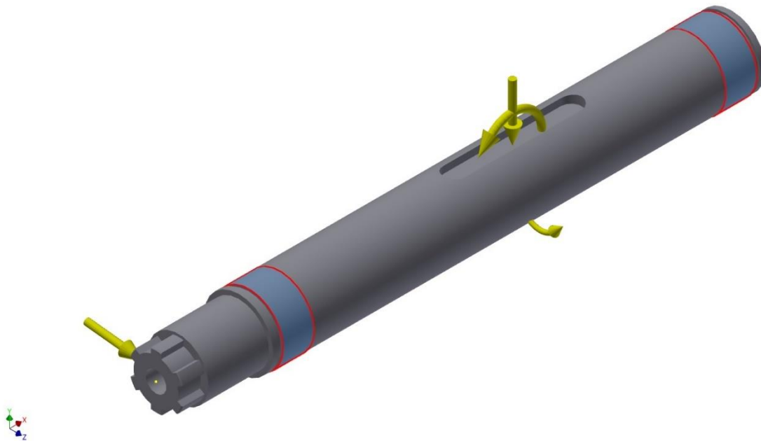
Obr. 25 Výstupní hřídel s okrajovými a počátečními podmínkami
