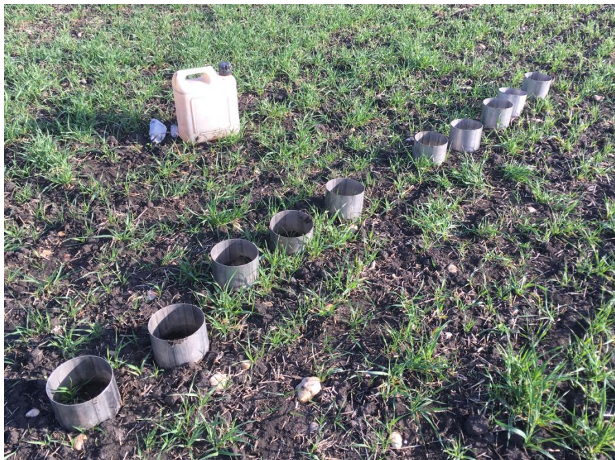
Obr. 6 - Měření infiltrace půdy pomocí ocelových válečků
