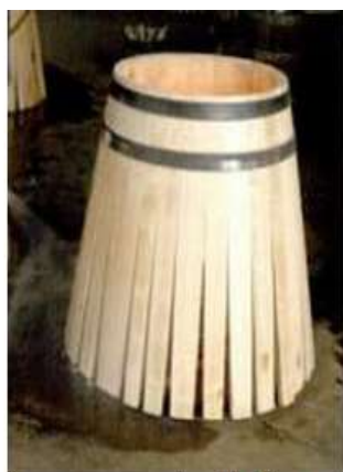
Dužiny ve tvaru rozkvetlé růže a aplikace horké vody pro zvýšení ohebnosti dřeva.
