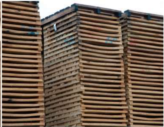
Dřevěné desky, připravené k sušení (rozložení umožňuje rovnoměrnou cirkulaci vzduchu)
