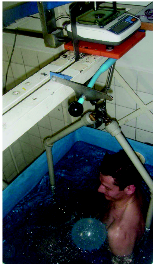
Obrázek 20: Zařízení pro podvodní vážení [60]
