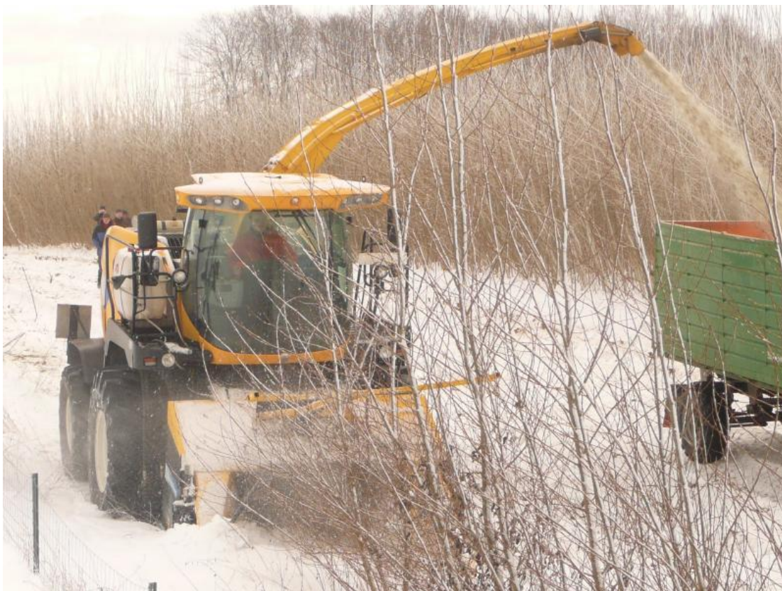
Příloha č. 13 - Samojízdná sklízecí topolová řezačka při sklizni
