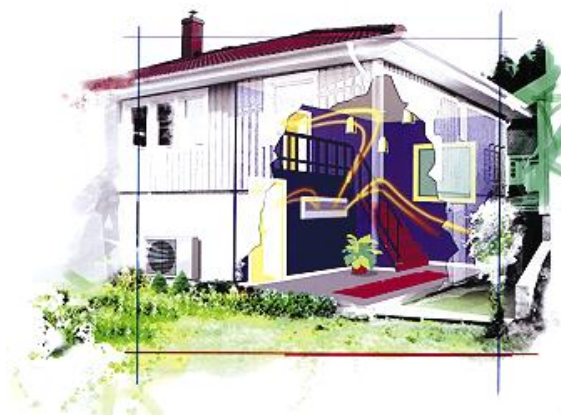
Obr. 2 Tepelné čerpadlo vzduch – vzduch (archiv IVT)
