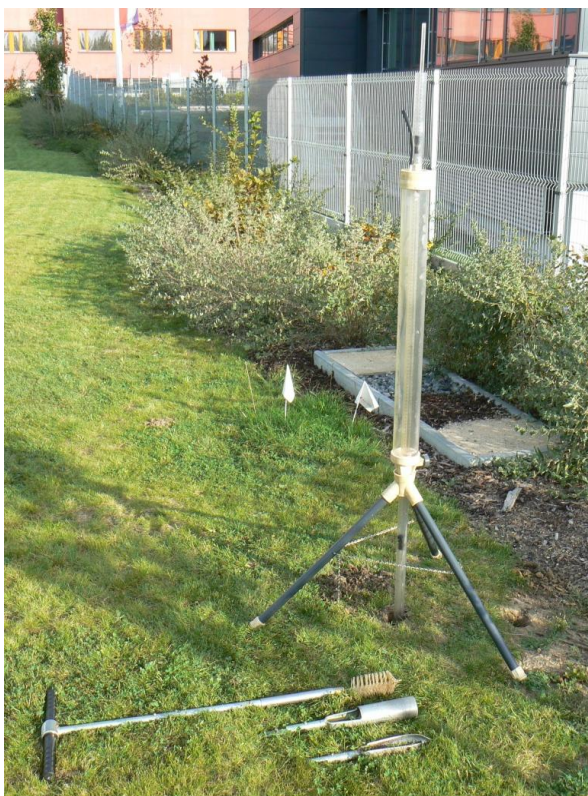
Obr. 15 Měření infiltrace Guelphským permeametrem
