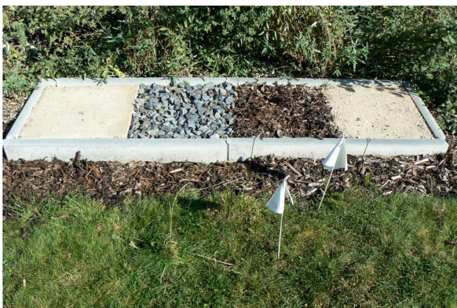
Obr. 14 Měření teploty a vlhkosti pod různými povrchy
