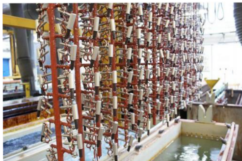
Obr. 28 Pokovovací lázeň závěsná (vlevo) a bubnová (vpravo) [31],[33]
