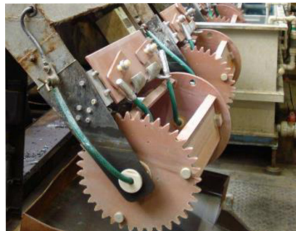
Obr. 28 Pokovovací lázeň závěsná (vlevo) a bubnová (vpravo) [31],[33]
