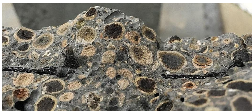
Obrázok 5 Rez Agloporitbetónom vyrábaný v spoločnosti Svoboda a syn s.r.o. [8]
