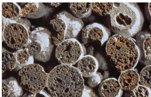
Obrázok 3 Rez zmesou Liapormixu od spoločnosti Lias Vintířov, ľahký stavebný materiál, k.s. [30]
