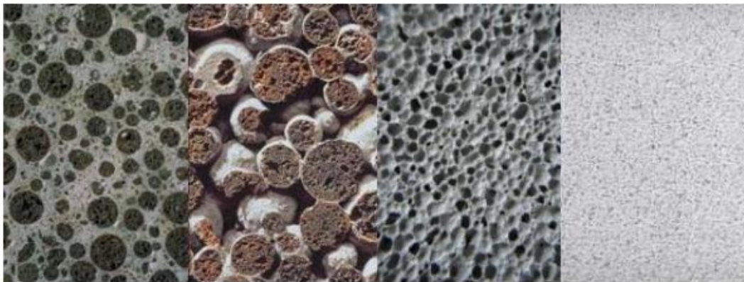
Obrázok 1 a) betón s hutným cementovým tmelom a použitím pórovitého kameniva b) medzerovitý betón s použitím pórovitého kameniva c) penobetón d) pórobetón [12]
