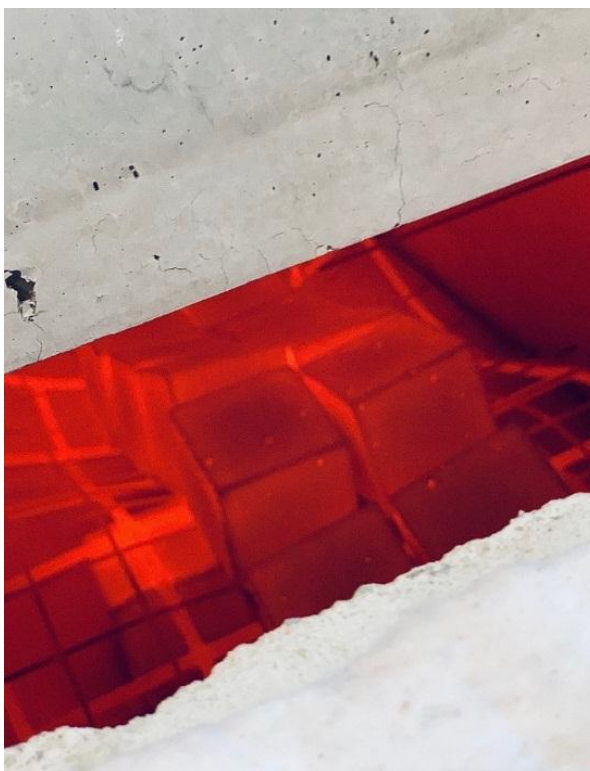
Obrázok 17 Pohľad na pecnú zostavu so zaklopením pomocou vyrobených skúšobných betónových panelov, Obrázok 18 Pohľad do pece pri teplotnom zaťažovaní 1000°C
