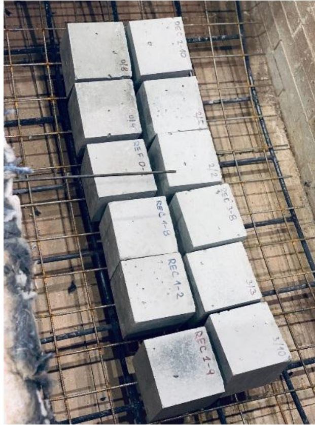
Obrázok 16 Uloženie skúšobných vzoriek do pece
