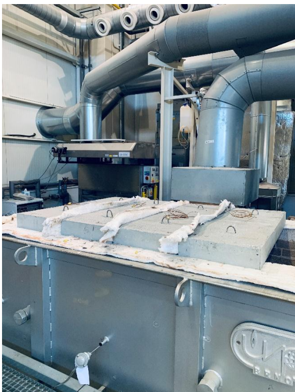
Obrázok 17 Pohľad na pecnú zostavu so zaklopením pomocou vyrobených skúšobných betónových panelov, Obrázok 18 Pohľad do pece pri teplotnom zaťažovaní 1000°C
