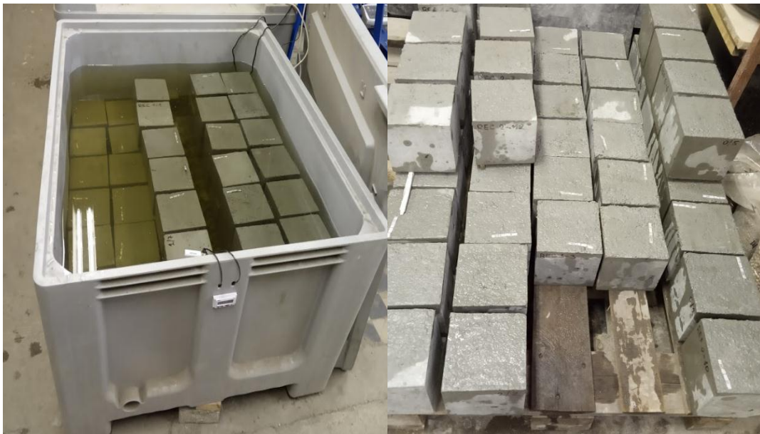
Obrázok 15 Uloženie vo vode a následné vysušenie na vzduchu pri laboratórnej teplote
