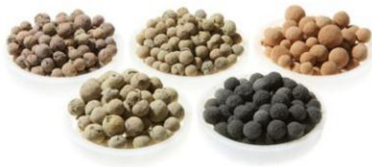
Obrázok 4 Rôzne typy Agloporitu v závislosti na vstupnej surovine (popolčeky z rôznych lokalít, uhoľný a tehelný prach) [8]
