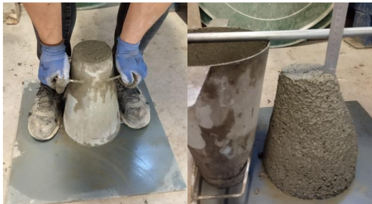
Obrázok 13 Stanovenie konzistencie pomocou skúšky sadnutia na receptúre REC 2 . Výška sadnutia bola 60 mm čo odpovedá triede S2
