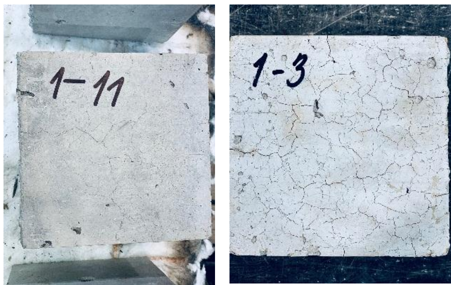
Obrázok 19 Povrchové zmeny betonu, vzoriek receptúry s označením REC 1 . Vzorka 1-11 zaťažovaná 800°C so šedou farbou povrchu a viditeľnými trhlinami. Vzorka 1-3 so značne bledšou farbou a mierne rúžovým/oranžovým nádychom so značne porušeným povrchom.
