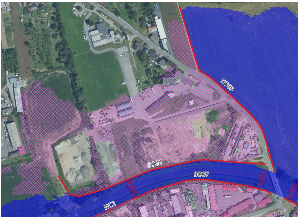
Obr. 45 SO04 (ochranná stena), SO05 (ochranná hrádzka), r.km 6,350 - 6,810
