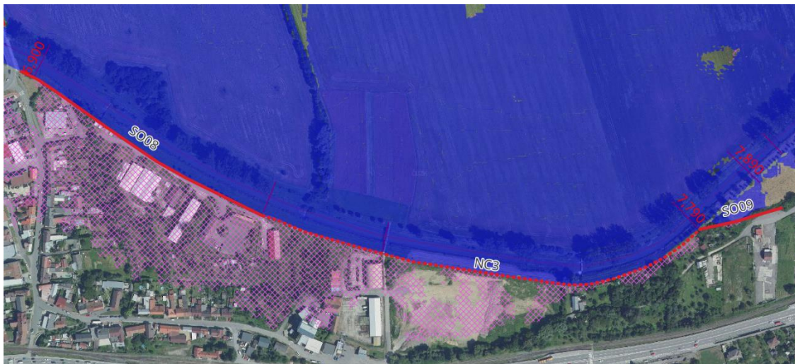
Obr. 49 SO08 (ochranná stena), NC3 (navýšenie cyklotrasy), SO09 (ochranná hrádzka), r.km 6,900 - 7,890
