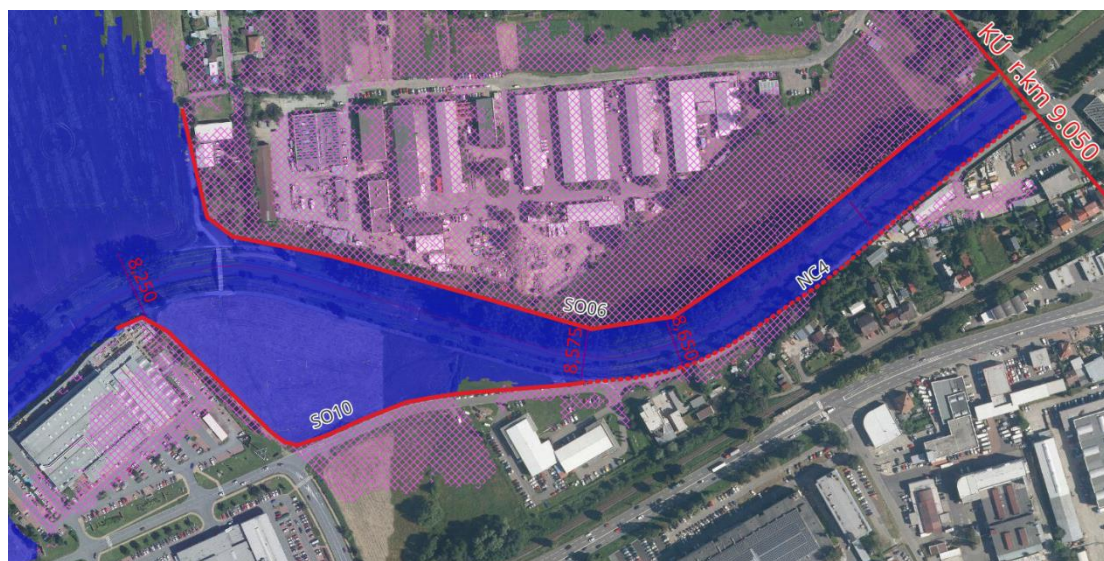
Obr. 50 SO10 (ochranná hrádzka), NC4 (navýšenie cyklotrasy), r.km 8,240-9,050
