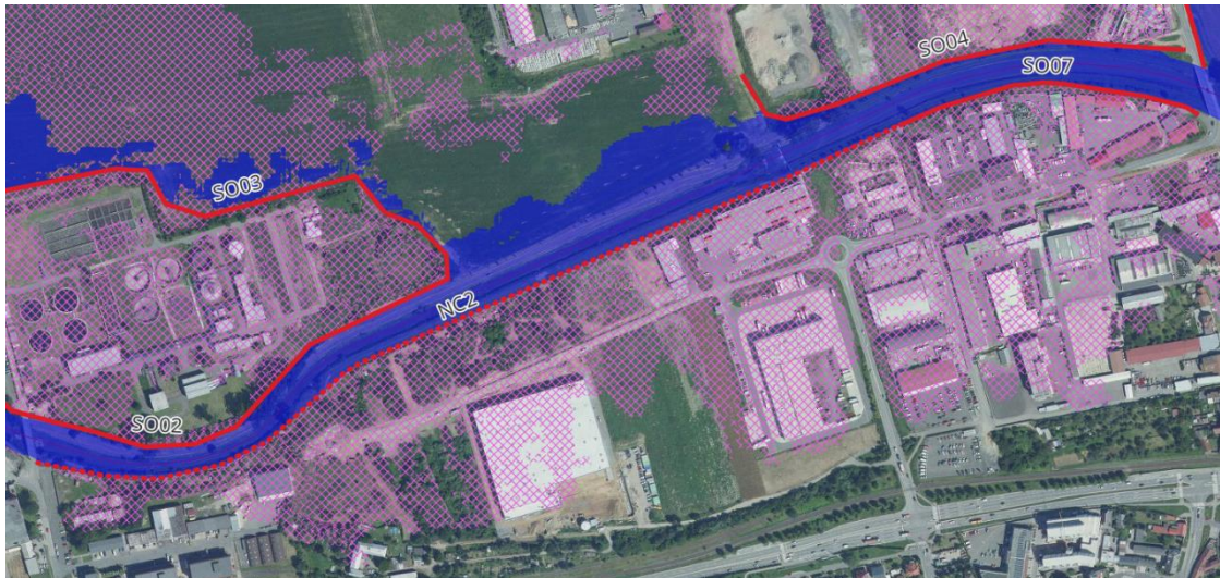
Obr. 48 NC2 (navýšenie cyklotrasy), SO07 (ochranná hrádzka), r.km 5,510 - 6,820
