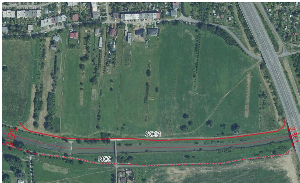
Obr. 33 PPO - ochranná hrádza SO01, r.km 2,720 - 3,361
