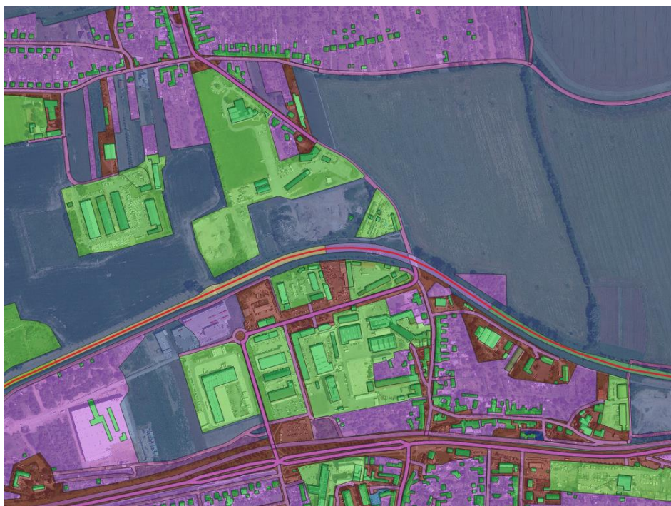
Obr. 21 Ukážka rozdelenia plôch pre jednotlivé drsnosti
