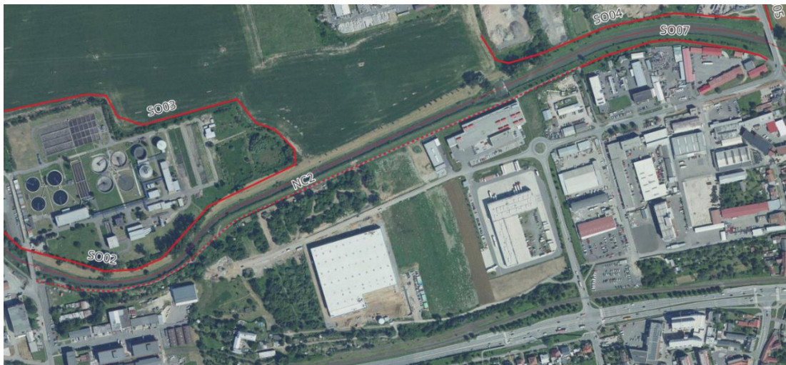
Obr. 39 PPO - navýšenie cyklotrasy NC2, ochranná hrádzka SO07, r.km 5,510 - 6,820
