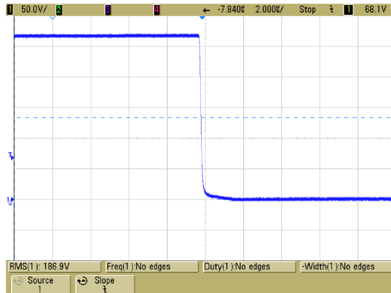
Obrázek 6.8 Detail přepínacího děje – sestupná hrana
