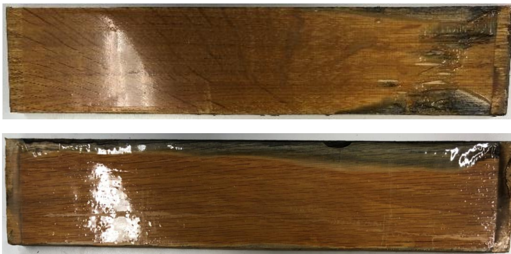
Obrázek č.32: Ukázka porušení nátěrového filmu (Foto: vlastní)
