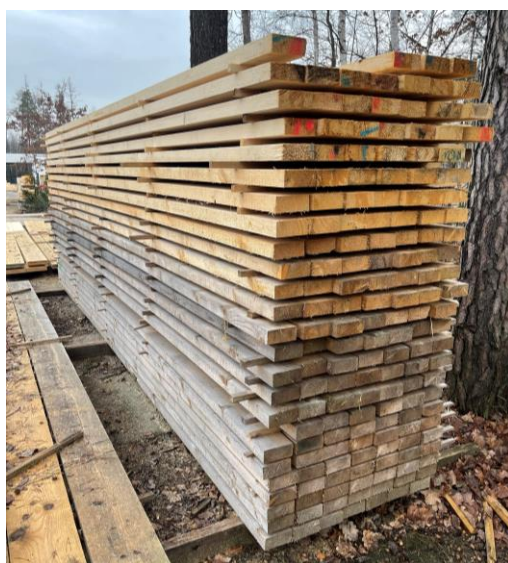
Obrázek 2: Postupná fotodegradace na řezivu (od spodu- nejstarší) (foto: vlastní)
