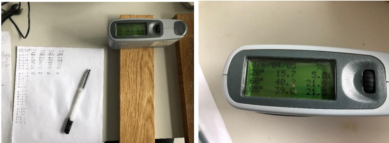
Obrázek č.19,20: Měření leskoměrem KSJ (Foto: vlastní)
