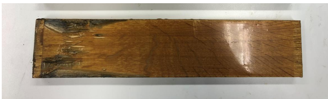
Obrázek 8: Příklad odloupení povrchové úpravy na levé straně vzorku (foto: vlastní)
