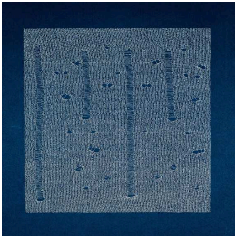
Obr. č. 44: Zátěžná jednolící pletenina s petinetovými otvory a ažurou; tmavý podklad
