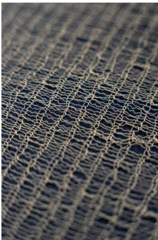
Obr. č. 35: Detail zátažné jednolící pleteniny; plete každá sudá jehla
