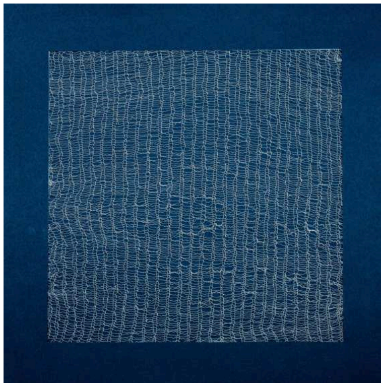
Obr. č. 32: Zátěžná jednolící pletenina; pletena na každé sudé jehle; tmavý podklad
