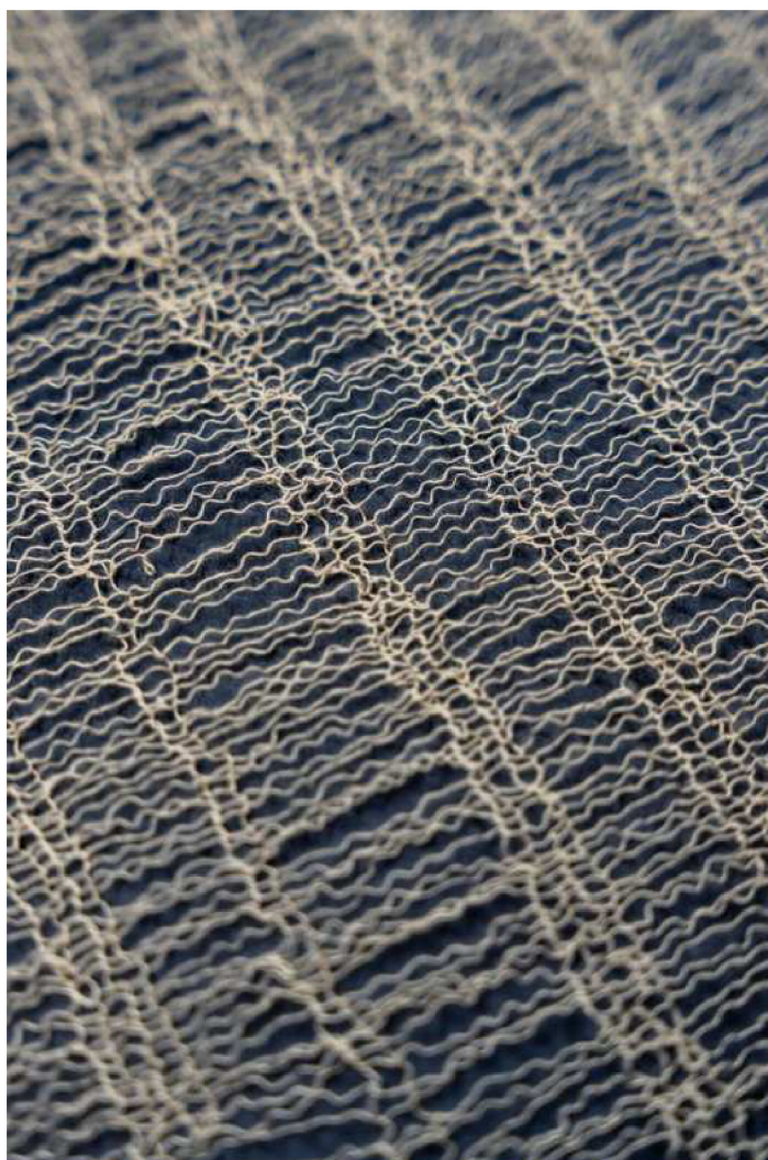
Obr. č. 39: Detail zátažné jednolící pleteniny; 2 jehly pletou, 3 nepletou
