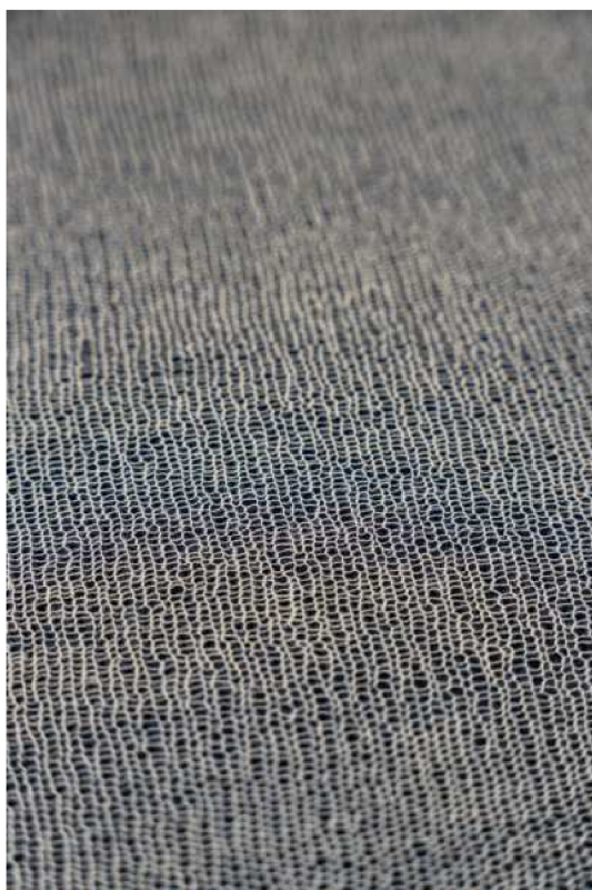
Obr. č. 31: Detail zátažné jednolící pleteniny; plete každá jehla
