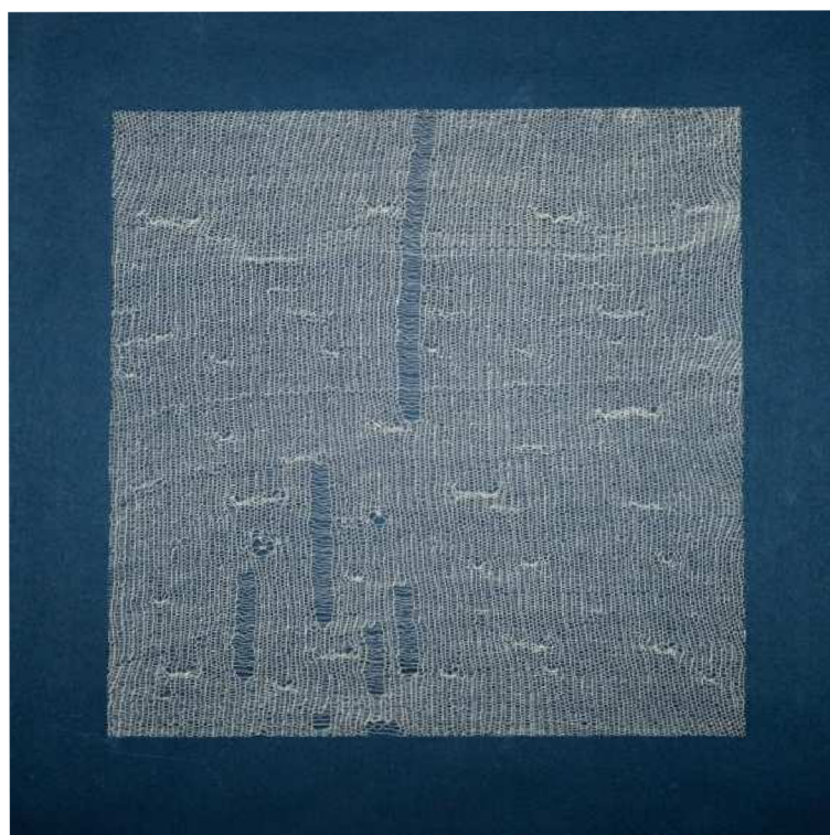
Obr. č. 47: Zátažná jednolící pletenina s chytovými a podloženými kličkami a ažurou; tmavý podklad
