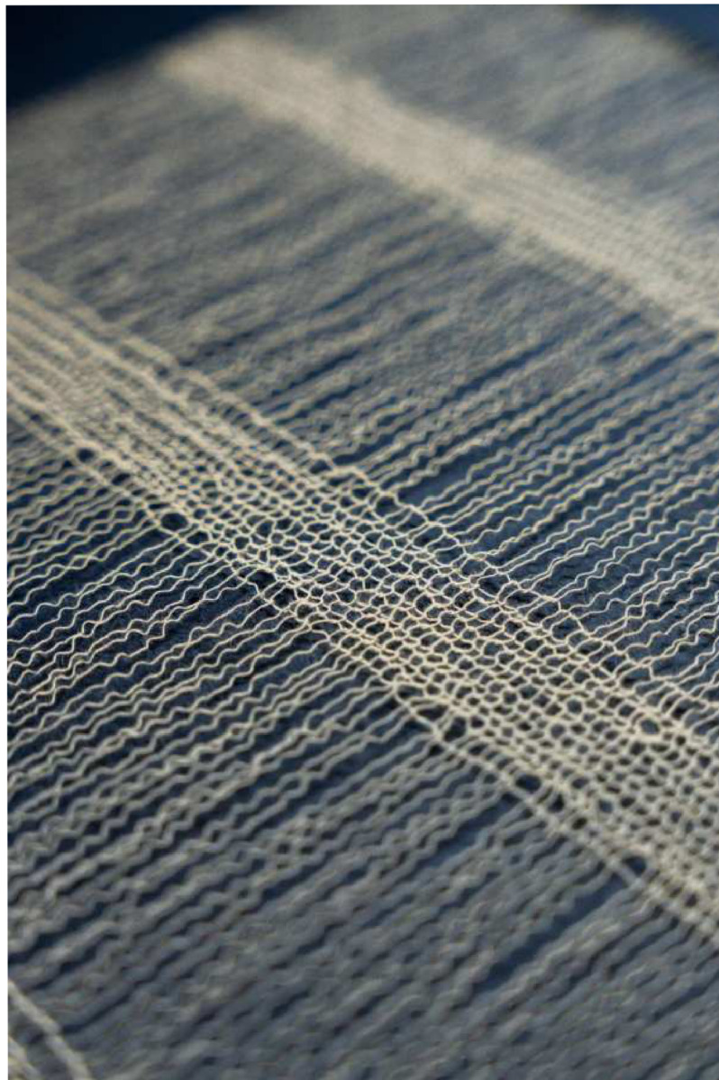
Obr. č. 43: Detail zátažné jednolící pleteniny; 6 jehel plete, 15 neplete
