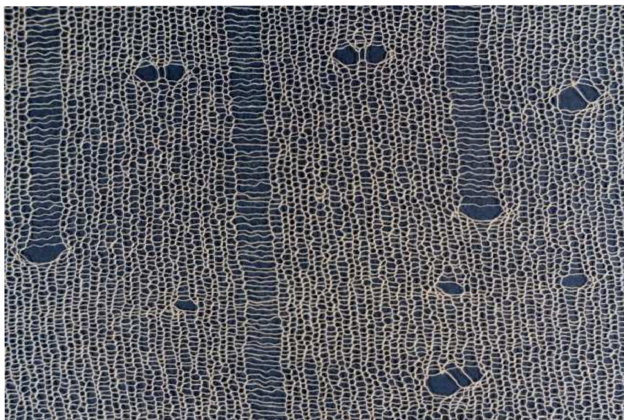
Obr. č. 46: Detail zátažné jednolící pletenina s petinetovými otvory a ažurou
