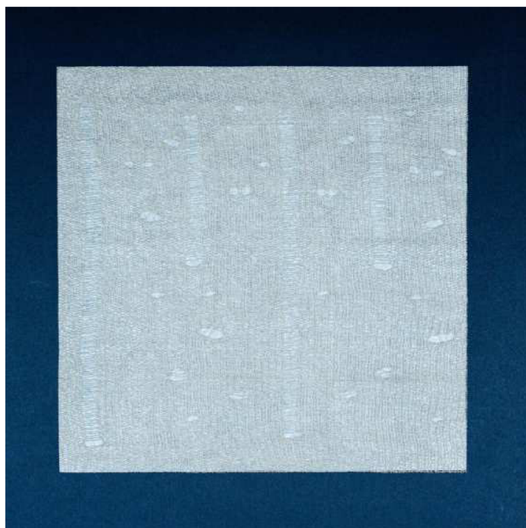
Obr. č. 45: Zátěžná jednolící pletenina s petinetovými otvory a ažurou; světlý podklad
