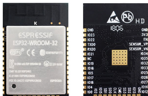
Obrázek 2.4: Modul ESP-WROOM-32. Uprostřed modulu lze vidět, kde je uvnitř zakomponovaný čip ESP32-D0WDQ6. (Obrázek přejat z: http://www.electronics-lab.com/getting-started-esp32/ )
