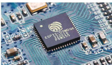
Obrázek 2.3: Na obrázku je vidět čip ESP32-D0WDQ6, který je základem platformy firmy Espressif Systems. (Obrázek přejat z: https://www.macnica.eu/node/267 )
