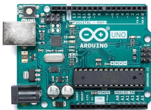
Obrázek 2.5: Vývojová deska Arduino UNO – na obrázku lze vidět rozložení pinů na desce. (Obrázek přejat z: https://articulo.mercadolibre.com.ar/MLA-775167821-curso-arduino-desde-cero-a-avanzado-ejercicios-y-teorias-_JM?quantity=1 )
