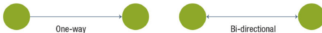
Obrázek 2.22: Schéma propojení v topologii typu point-to-point — jednosměrná a obousměrná komunikace (Obrázek přejat z: http://archive.rtc magazine.com/articles/view/102871 )
