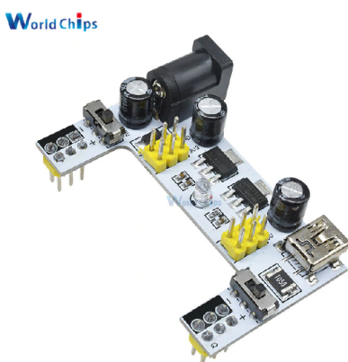
Obrázek 2.14: Na obrázku lze vidět výstupní konektory, které jsou realizovány formou přepínačů a nebo stálých výstupních pinů. Při připojení zařízení je důležitá jeho orientace. (Obrázek přejet z: https://ja.aliexpress.com/item/32821750004.html )
