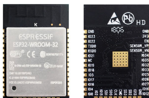
Obrázek 2.4: Modul ESP-WROOM-32. Uprostřed modulu lze vidět, kde je uvnitř zakomponovaný čip ESP32-D0WDQ6. (Obrázek přejat z: http://www.electronics-lab.com/getting-started-esp32/ )
