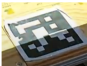
Obrázek 5.3: Osvícení kalibračního vzoru znemožňující kalibraci.
