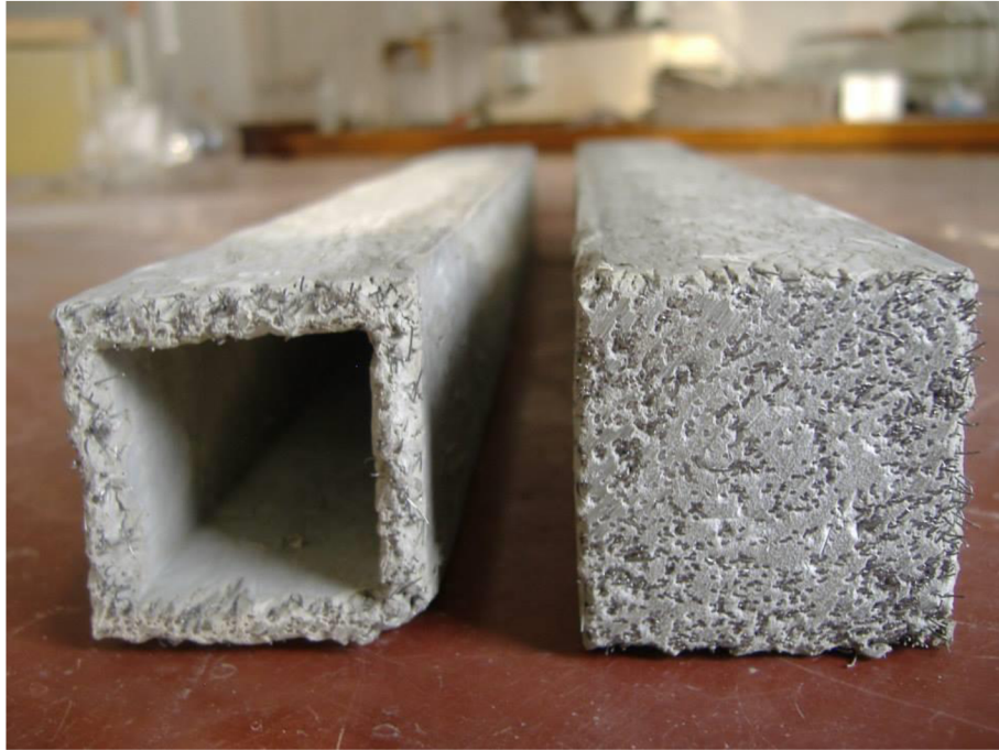
Obr. 16: Extrudované vláknocementové profily s obsahem mikroocelové rozptýlené vláknové výztuže Krampe DM v množství 40 % hmotnostně na portlandský cement – receptura č. 208
