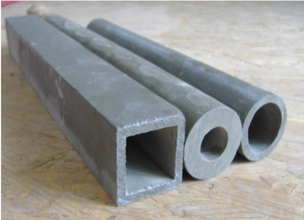
Obr. 14: Extrudované vláknocementové profily s obsahem skelné rozptýlené vláknové výztuže Cem–FIL 70/30 – 12 mm v množství 12 % hmotnostně na portlandský cement – receptura č. 140
