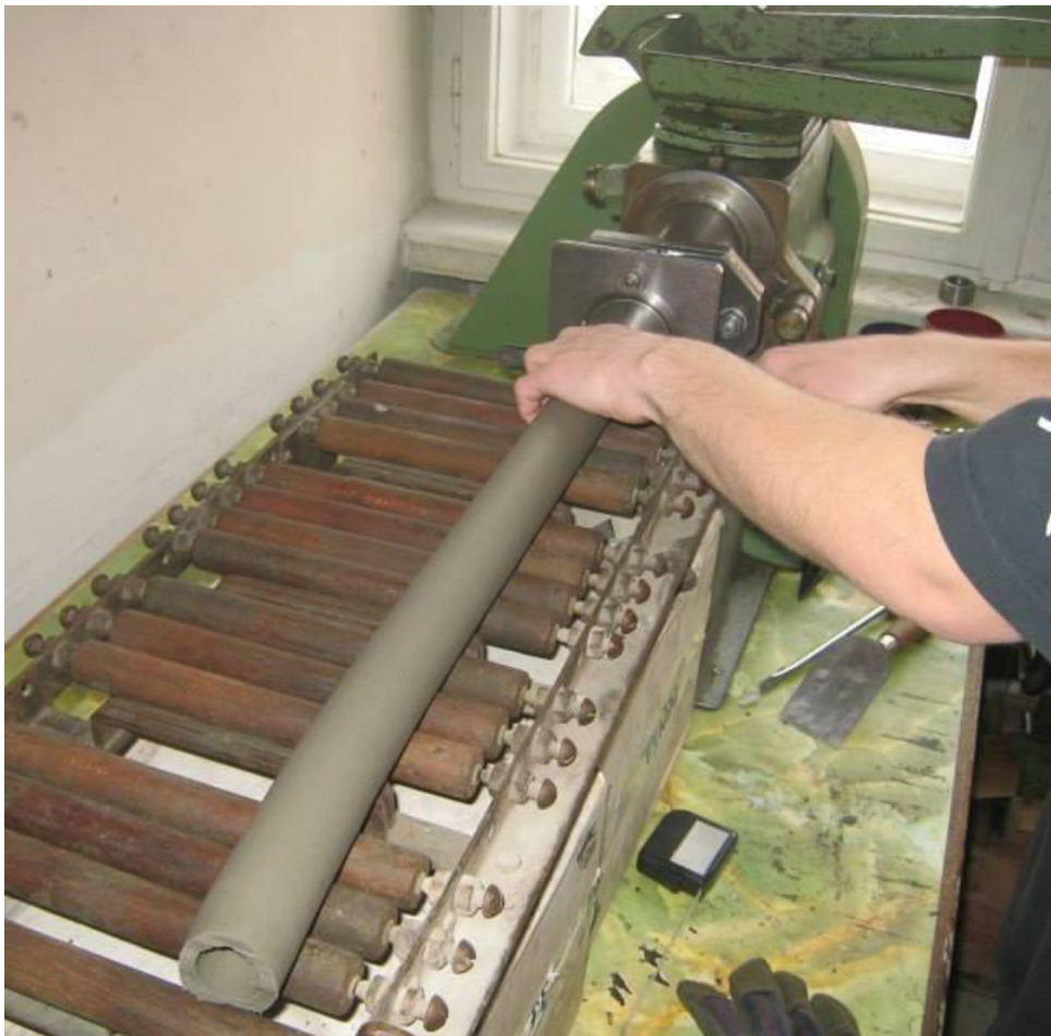
Obr. 17: Extruze vláknocementového profilu o průměru 40 mm a tloušťce stěny 5 mm – receptura č. 140
