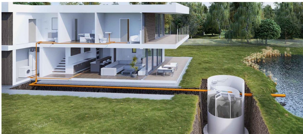
Obrázek 11: Návrh uspořádání domovní čistírny [97]
