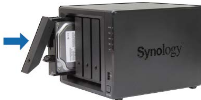
Obrázek 34: Instalace HDD do NAS
