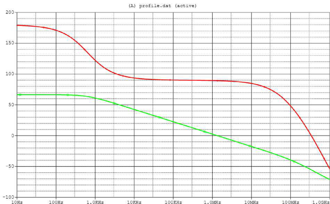
Obrázek 4-13:Kmitočtové charakteristiky složené kaskody
