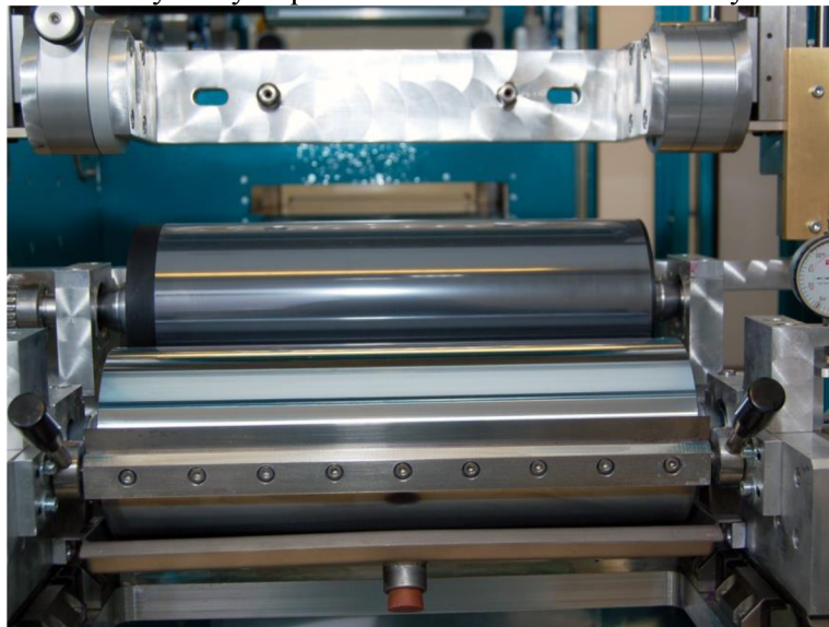
Obr. 28 Fotografie hladkého ovrstvovacího válce s chemicky odolnou miskou a stěrkou a gumového tlakového válce, nad nímž je zařízení pro uchycení slotu.
