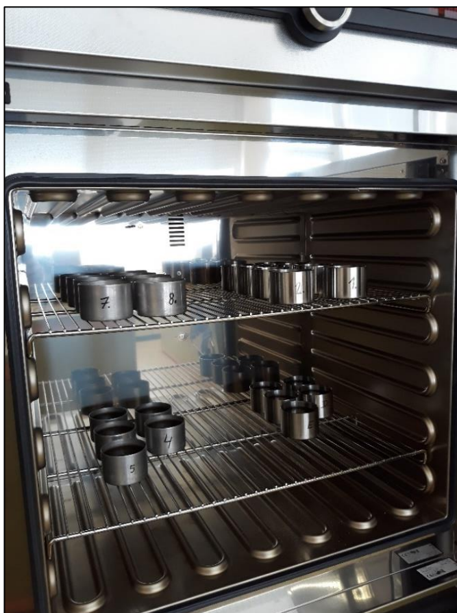
Obr. č. 12: Sušárna se vzorky půdních agregátů (autor, 2022)
