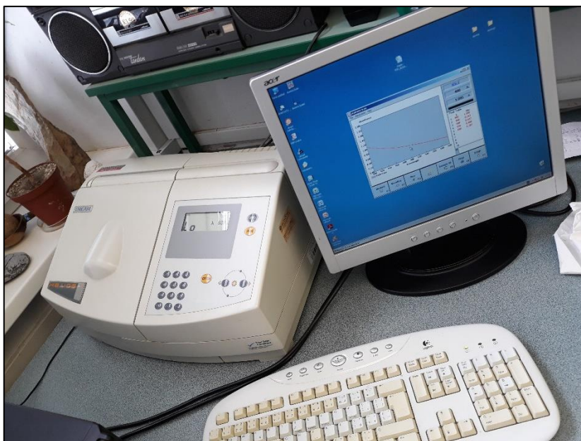
Obr. č. 14: UV-VIS spektrofotometr (autor, 2022)
