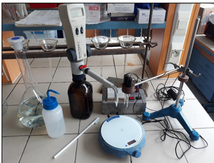
Obr. č. 13: Přímá titrace (stanovení množství C_{\text{ox}} ) Mohrovou solí (autor, 2022)
