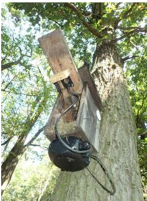
Obr. 4: RFID čtečka s infračidlem před a za vletovým otvorem. Foto: Miloš Krist.
