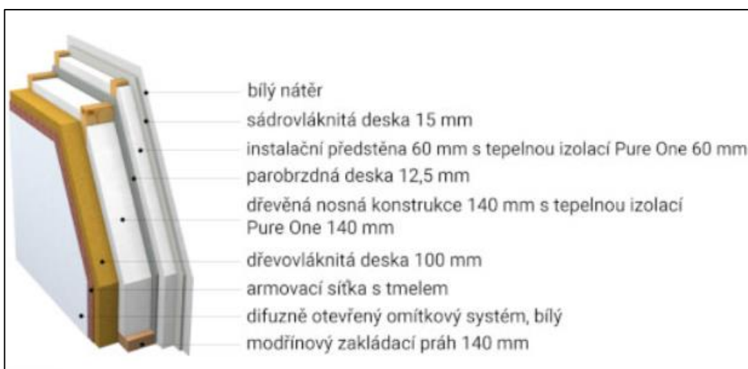
Obr. 10. Příklad skladby rámové konstrukce dřevostavby [42]
