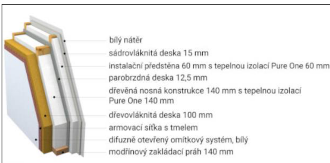
Obr. 10. Příklad skladby rámové konstrukce dřevostavby [42]
