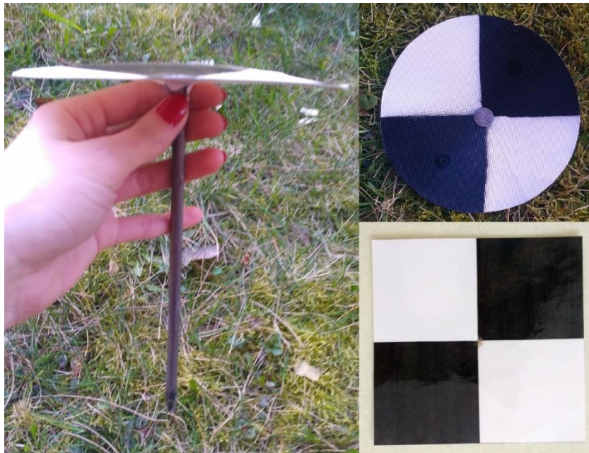
Obr. 6.5 Ukázka stabilizace a signalizace bodů.
