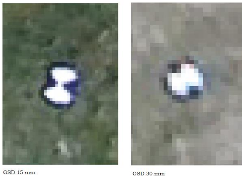
Obr. 6.7 Ukázka viditelnosti terčů na snímcích při různých hodnotách GSD.
