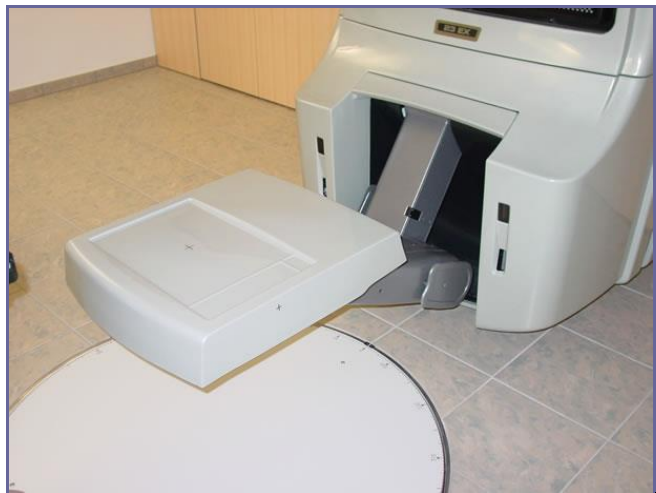
Obr. 30: Elektronický portálový zobrazovací systém (EPID) – panel s detektorem (zdroj: FN Motol)
