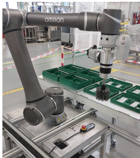
Obr. 27 Pracovní stanice kobotu v rámci testování čištění útroby těl filtrů ve společnosti Mann+Hummel (foto autor BP).
