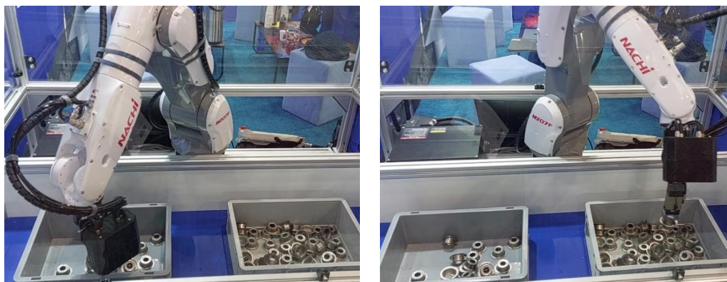
Obr. 23 Demontrace bin pickingu – expozice firmy SANEZOO Europe – MSV 2023 (foto autor BP).
