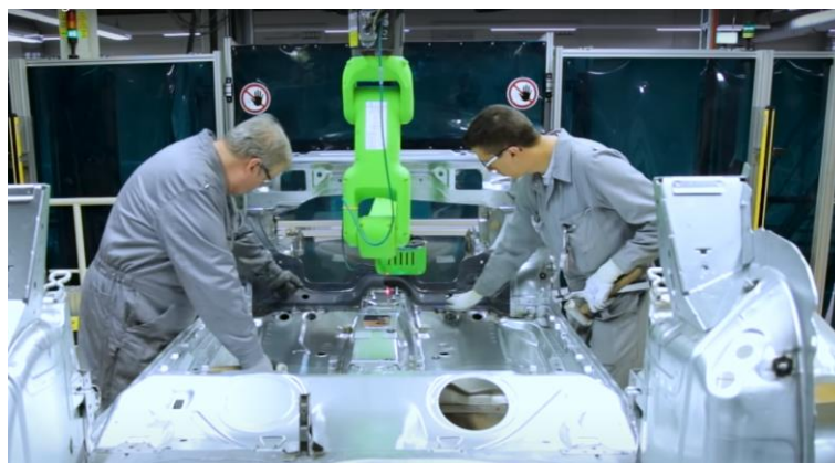
Obr. 32 Inspekce kvality svarů v belgickém závodu automobilky Audi při jejich současném odstraňování strusky a nečistot pracovníky, převzato z: [49].
