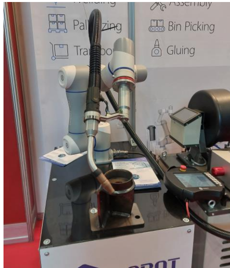
Obr. 9 Technologický efektor – MIG/MAG svářečka, expozice firmy Robix Automation s.r.o. – MSV 2023 (fotografie autor BP).
