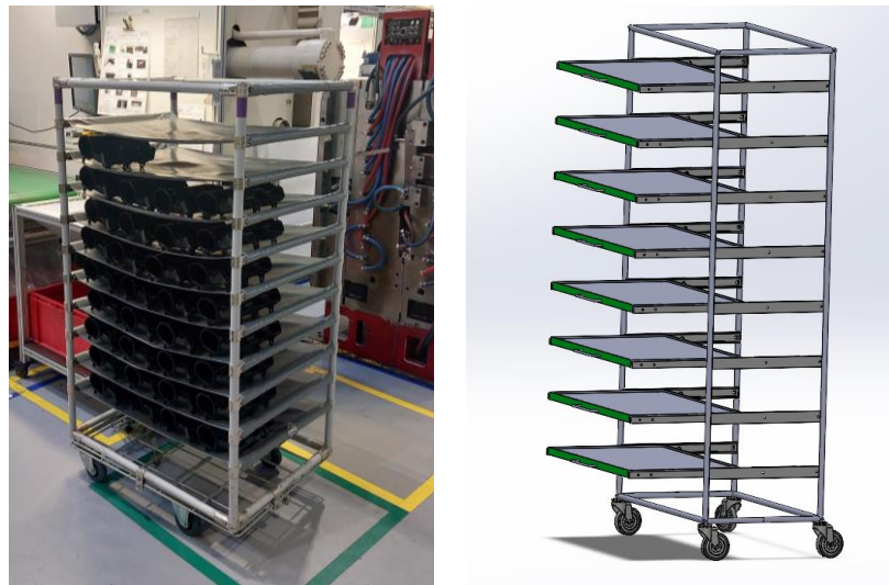
Obr. 49 Demonstrace současné konstrukce manipulačních jednotek a návrh nového konceptu (foto autor BP).
