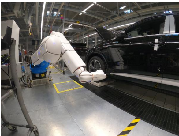
Obr. 50 Implementace technologie AIRSKIN v saském závodě společnosti Volkswagen, převzato z: [73].
