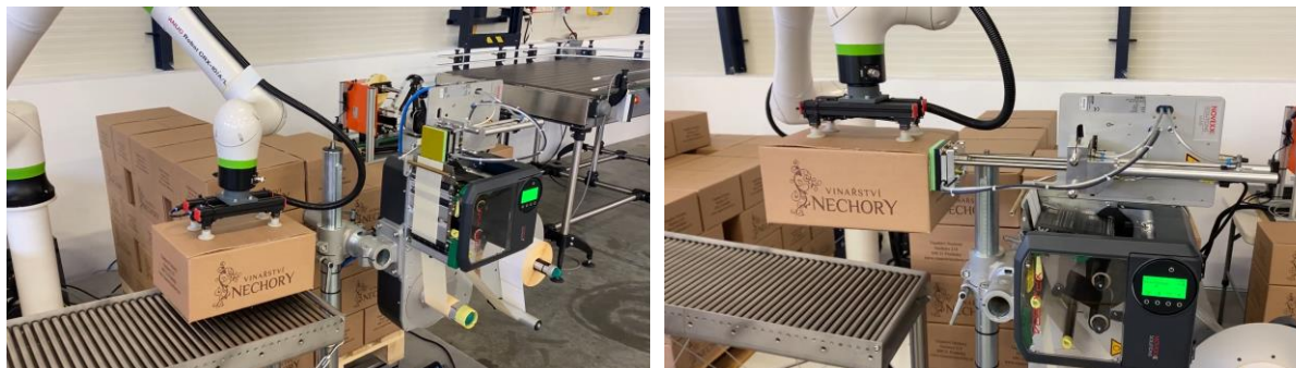
Obr. 33 Demonstrace použití kobotu pro paletizaci kartonů vína a etiketizaci, převzato z: [50].
