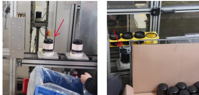
Obr. 46 Demonstrace úkonu osazení pružinou a víkem, (foto autor BP).
