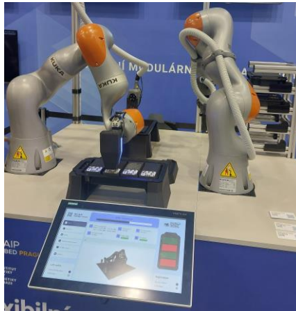
Obr. 24 Démonstrace montáže PCB desek do přípravku – expozice Českého institutu informatiky, robotiky a kybernetiky ČVUT v Praze – MSV 2023 (foto autor BP).
