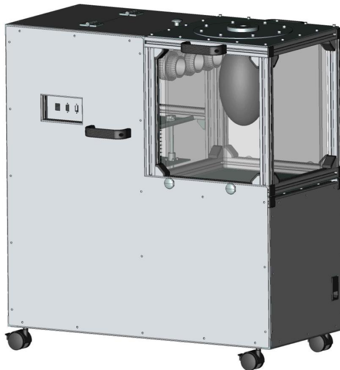
Obrázek 1.1 Mechanický plicní simulátor i-Lung 2.0 (převzato z [14]).
