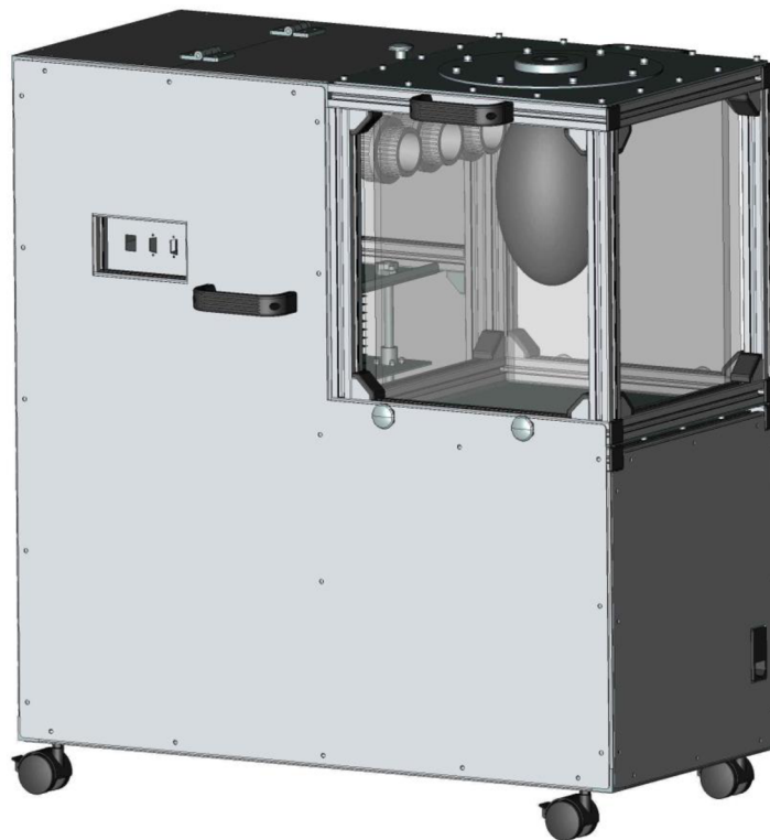
Obrázek 1.1 Mechanický plicní simulátor i-Lung 2.0 (převzato z [14]).
