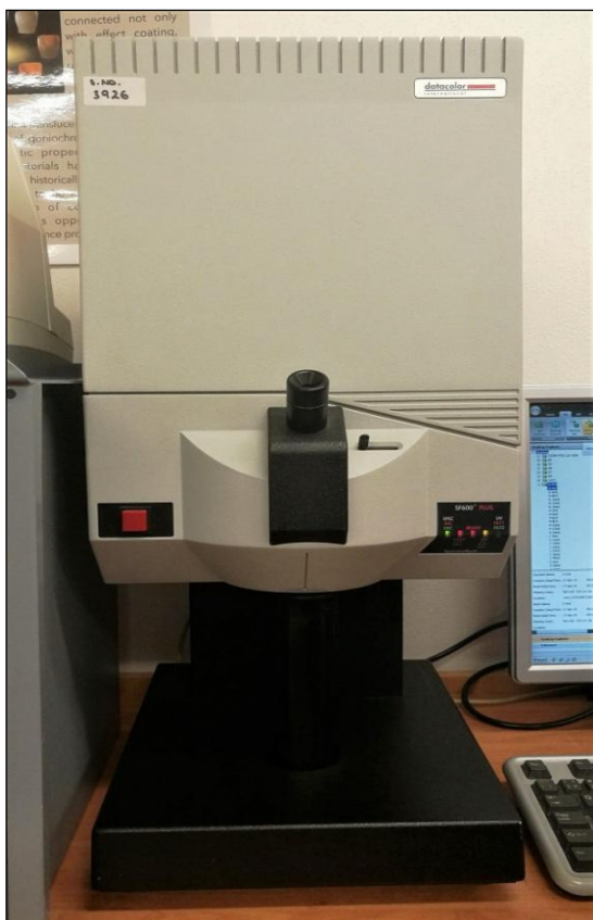
Obrázek 10. Datacolor SF600 Plus – spektrofotometr [Zdroj: autor]
