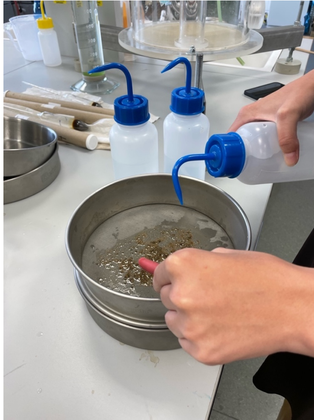
Obrázek 10: Prosévání vzorku mokrou cestou přes síto o velikosti ok 0,25 mm
