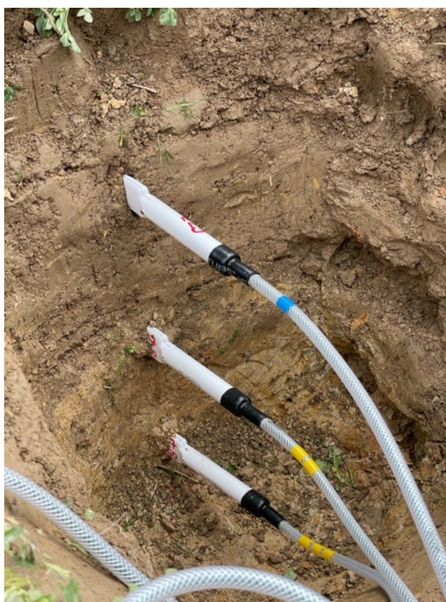
Obrázek 14: Osazené senzory TOMST TMS-4 v půdě v hloubkách 20, 40 a 60 cm
