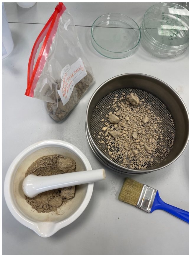
Obrázek 9: Rozmělnění porušeného půdního vzorku a jeho prosévání přes síto o velikosti ok 2 mm
