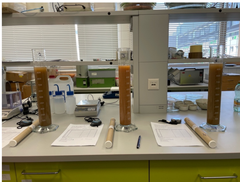
Obrázek 11: Příprava na měření hustot suspenzí v odměrných válcích
