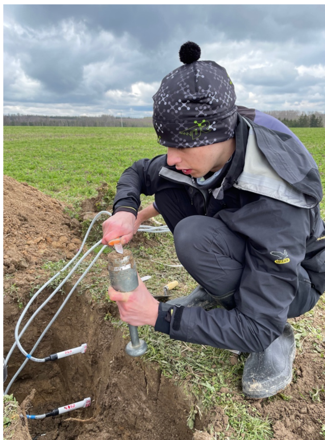
Obrázek 8: Zarovnání neporušeného půdního vzorku nožem
