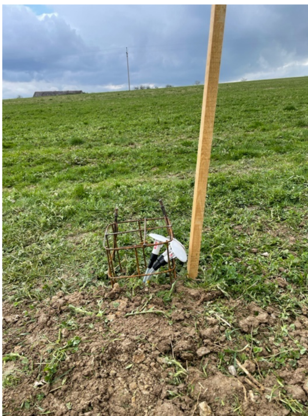
Obrázek 15: Vytažené konce kabelů od senzorů TOMST TMS-4 opatřené krycími plastovými čepičkami vytažené na povrch a umístěné v ochranné kovové kleci
