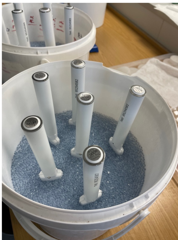
Obrázek 12: Senzory TOMST TMS-4 v kbelíku se sklenými kuličkami
