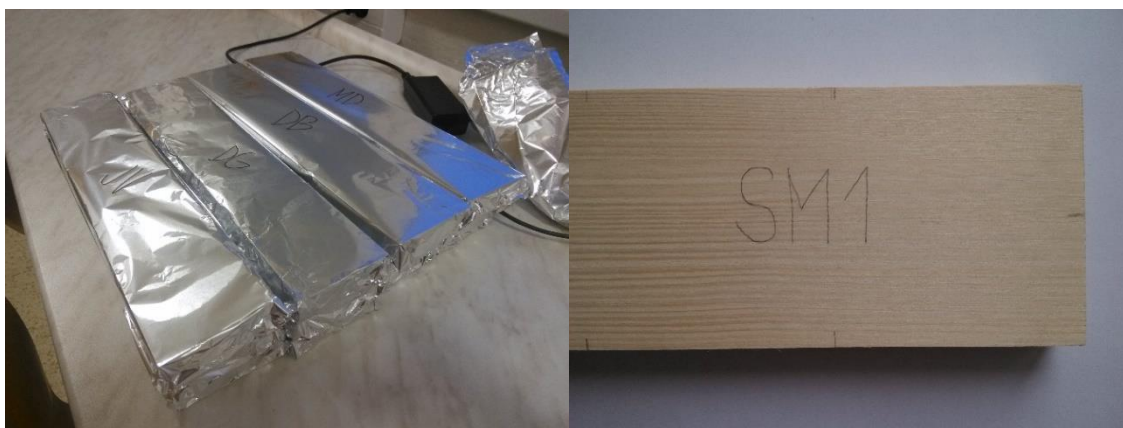
Obrázek 4.3: Příprava zkušebních těles – popis a uchování v Al folii (foto Oberhofnerová)
