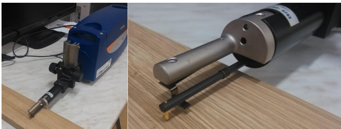
Obrázek 4.12: Určování drsnosti povrchu kontaktním profiloměrem (foto Oberhofnerová)
