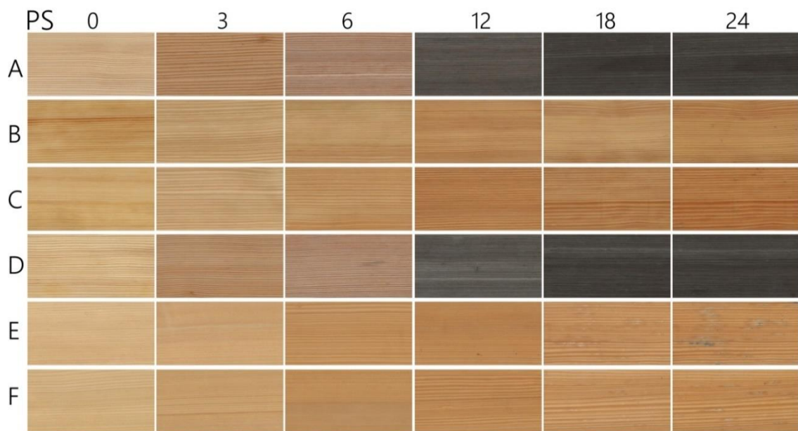
Obrázek 5.23: Vizuální podoba nátěrových systémů (A-F) během přirozeného stárnutí PS (po 0,3,6,12,18 a 24 měsících)
