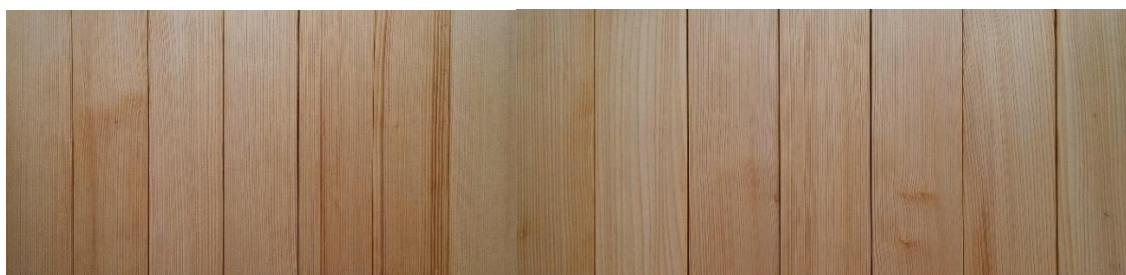
Obrázek 4.4: Ukázka sady ošetřené transparentním nátěrovým systémem (A) (foto Oberhofnerová)
