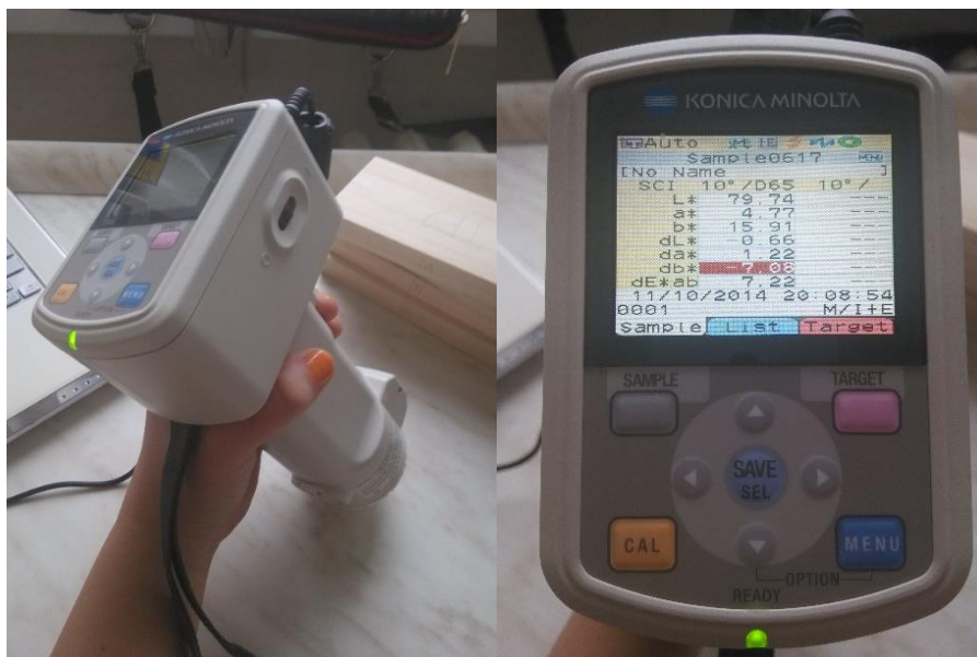
Obrázek 4.9: Měření barevných parametrů spektrofotometrem (foto Oberhofnerová)
