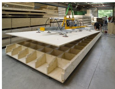
Obr. 10 Montáž panelů element (novatop-system.cz)
